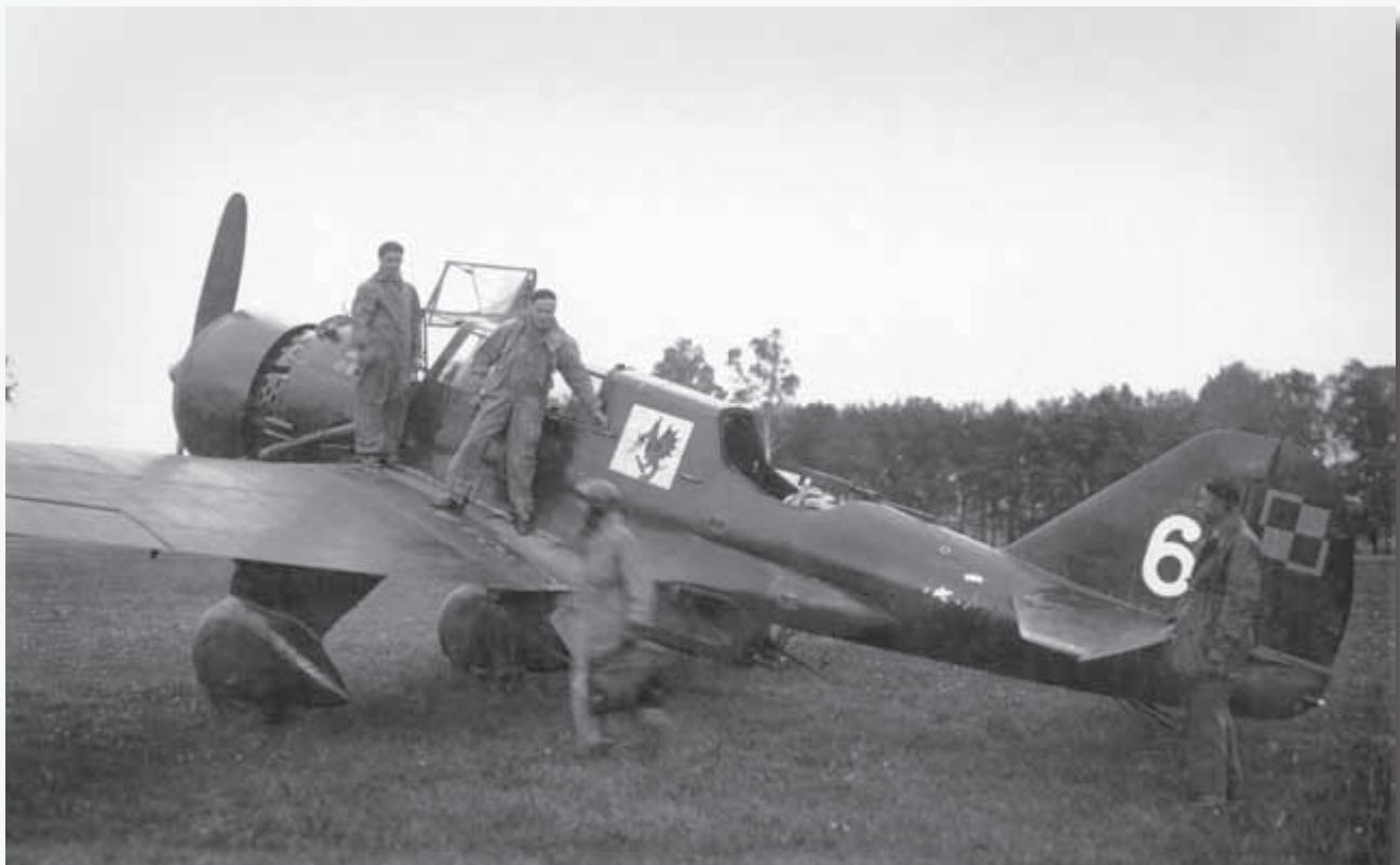
Załoga „Karasia” nr 6 z 22 Eskadry Liniowej zajmuje miejsca w maszynie przed startem z lotniska polowego. Na fotografii doskonale widać uzbrojenie strzeleckie samolotu, karabiny maszynowe typu Vickers F tylnego strzelca (górny kaem) i obserwatora (dolny kaem, umieszczony w tzw. „kołysce” pod kadłubem maszyny). Pilot maszyny miał do swej dyspozycji trzeci, zamontowany na stałe kaem (wz. 33), który był umieszczony po prawej stronie jego kabiny i strzelał do przodu pomiędzy cylindrami silnika. Uzbrojenie zaczepne samolotu stanowiły bomby o masie do 700 kg, podwieszane na wyrzutnikach umieszczonych w centroplacie, pomiędzy kołami podwozia
